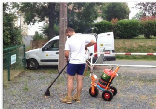
Cet équipement breveté fonctionne avec la technique de l'**air chaud pulsé**. Le système de chaleur pulsée produit un **choc thermique** sur les mauvaises herbes, et détruit les cellules qui se trouvent dans la plante, sans avoir à les brûler.
